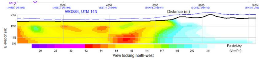
Imagen de Resistividad con Profundidad de ZTEM Inversion 2D en casi el mismo corte transversal / ZTEM 2D Inversion Resistivity Depth Image Line 2171 essentially on section.
